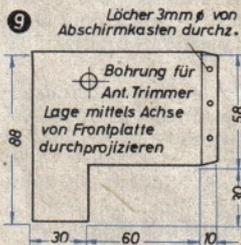
Abb. 8. Abschirmkasten; verz. Eisenblech Nr. 22. Abb. 9. Trennwand; verz. Eisenblech Nr. 22
