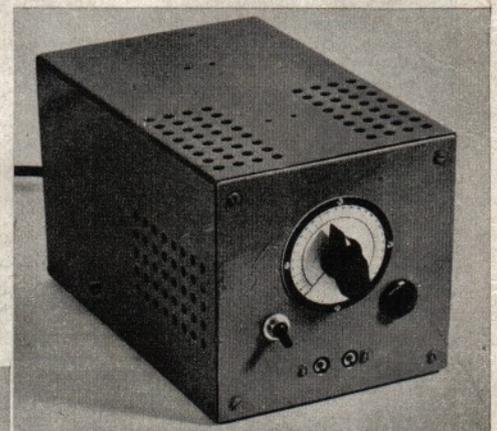
Rechteckgenerator. Bestückung EL 41 und AZ 41. Die Abmessungen des eisernen Einbaukastens sind: 15x15x23 cm
