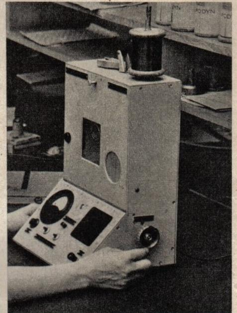
Abb. 5. Lackdrahtprüfgerät für Durchschlagsspannung
