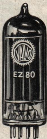
Die Valvo EZ 80 ist als Zweiweg-Gleichrichter für Rundfunk-Geräte entwickelt und mit Noval-Sockel ausgeführt. Ihr Katodenstrom von 90 mA reicht auch zur Speisung größerer AM/FM-Empfänger aus. Die Abbildung 1 zeigt die Strom-Spannungskennlinie einer Gleichrichterstrecke, aus der man den besonders niedrigen Innenwiderstand ablesen kann.
